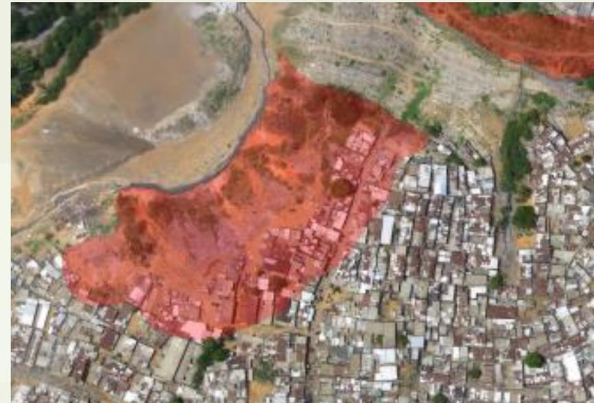
Le non-respect des normes de construction sur les sites à fortes pentes est la principale cause de l'effondrement des constructions dans les quartiers de la ville d'Abidjan. L'identification de ces espaces non-constructibles ou difficilement aménageables est un premier pas vers la mise en place de système de prévention des risques d'éboulement de terrain.
